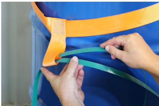
3. Umreifungsband durch die Schlaufen der Fass-Sicherung führen.
