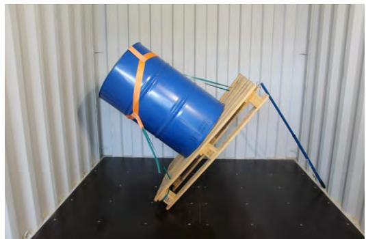
6. Das Stahlsickenfass ist gegen Kippgefahr gesichert und fertig für die Verladung.
