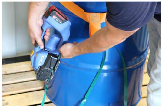
4. Mit einem Spanngerät die Bänder spannen, verschweißen und passend ablängen.
