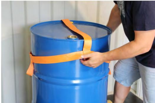
1. Fass-Sicherung auflegen und die Schlaufenenden zu den Palettenecken ausrichten.
