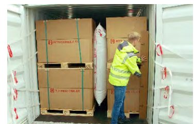
3. (R) Kantenschutz mit Ausfräsungen beidseitig positionieren.
