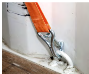
2. Haken zeigen zur Containerwand damit das Ladegut nicht beschädigt wird
