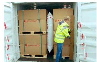
3. (R) Kantenschutz mit Ausfräsungen beidseitig positionieren
