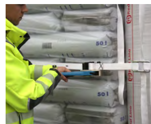
7. Querbänder mit Gurtschnalle schließen (siehe Beschreibung) und z.B. mit Haspelspanner, spannen
