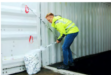
1. Gurtband bzw. Lashing anbringen Tipp: Mit (R) Tool Magnet einfach fixieren
