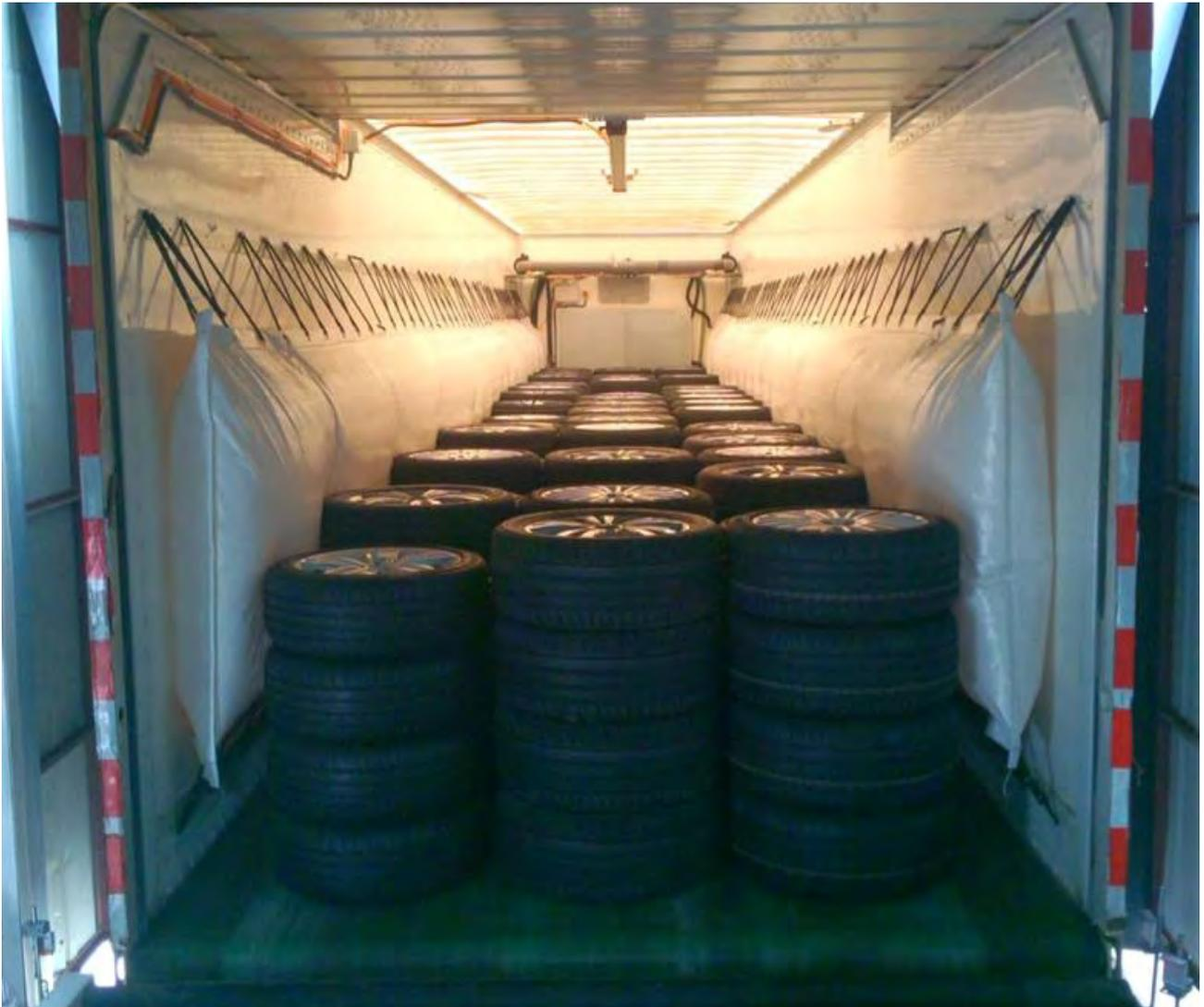
Der Vorteil unserer LKW Festeinbauten ist die zeitoptimierte Ladungssicherung von wiederkehrenden Verlade-situationen. Durch am LKW installierte Staupolster und eine innovative Befüllung ist die Ware sicher und mit wenigen Handgriffen gesichert.
