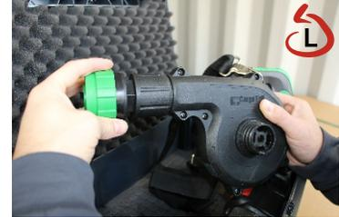
3. Befestigen Sie das Adapter am Gewinde des Akkugebläses. Drehen Sie in Pfeilrichtung (auf dem Gehäuse) nach Links, bis es fest sitzt.
