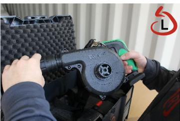
1. Befestigen Sie den Schlauch an dem Gerät, indem Sie ihn aufschrauben. Beim Gewinde handelt es sich um ein entgegengesetztes Gewinde: Links herum aufschrauben.
