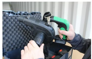
3. Um das Gerät zu nutzen, um die Luft aus einem Polster abzusaugen, befestigen Sie den Schlauch an der Seite des Geräts wie zuvor in Schritt 1 und 2 beschrieben.
