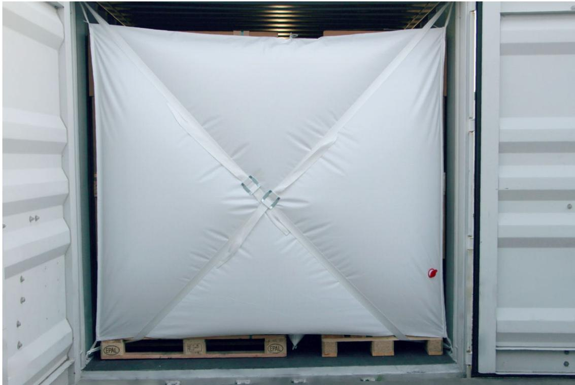
(R) Full Safety ist unser vollflächiges Rückhaltesystem für den Einsatz im Container, um empfindliche und kleine Packstücke sicher von der Tür zurückzuhalten. Es ist als Rückhaltesystem mit eingearbeiteter Plane oder eingearbeitetem Luftpolster und unterschiedlichen Gurtstärken erhältlich.
