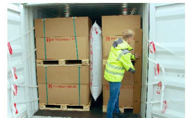
3. (R) Kantenschutz mit Ausfräsungen beidseitig positionieren
