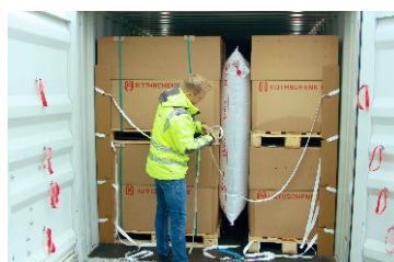
5. Gurtbänder mit (R) Tools Gurtschnallen und Haspelspanner/Akkuspanner anziehen
