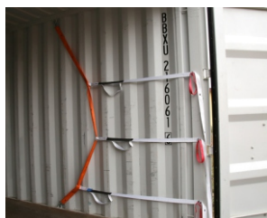
5. Querbänder an der Containerwand fixieren, z.B. mit unseren Magneten
