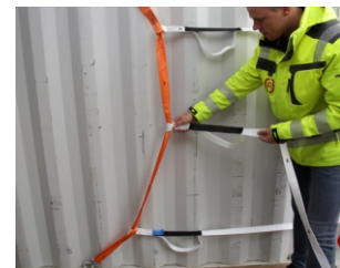
4. Höhe des mittleren Querbandes einstellen - falls möglich
