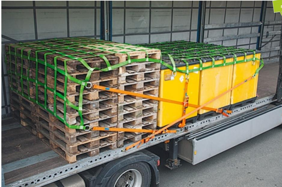
Sicherungsnetze kommen immer dann zum Einsatz, wenn Ladung kleinteilig ist oder großflächig gesichert werden muss. Ziel ist es dabei lose Ware vor dem Herabfallen bzw. Hochschleudern zu sichern. Zudem ist auch ein Einsatz als Trennnetz möglich. Rothschenk Sicherungsnetze finden Anwendung bei PKW Anhängern, LKWs und kleinen Transportern bis 3,5 Tonnen.
