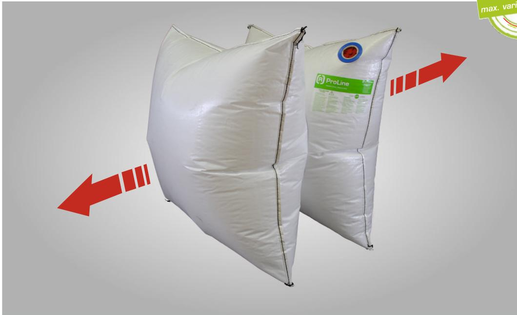
Größere Staulücken können in beide Fahrtrichtungen quer und längs auftreten. Da diese nur bis 800 mm zuverlässig von einem 3D-Stausack ausgefüllt werden können, war hier eine besondere Lösung nötig. Die Rothschenk Entwicklungsabteilung hat hierzu ein Doppelkammerpolster entwickelt, das hohe Druckkräfte aufnehmen kann und zugleich flexibel sowohl kleine wie große Zwischenräume ausfüllt - also maximal variabel.
