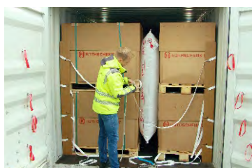
5. Gurtbänder mit [R] Lashing Gurtschnallen und Haspelspanner/Akkuspanner anziehen.
