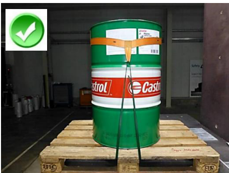
Abb. 1-2: Metallfass mit PET-Band und PE-Fass mit PET-Band und Anwendung
