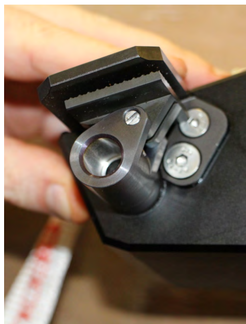
Automatisch öffnende/schließende Bandbremse
