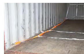
Flex. Zurrpunkte längs der Containerwand
