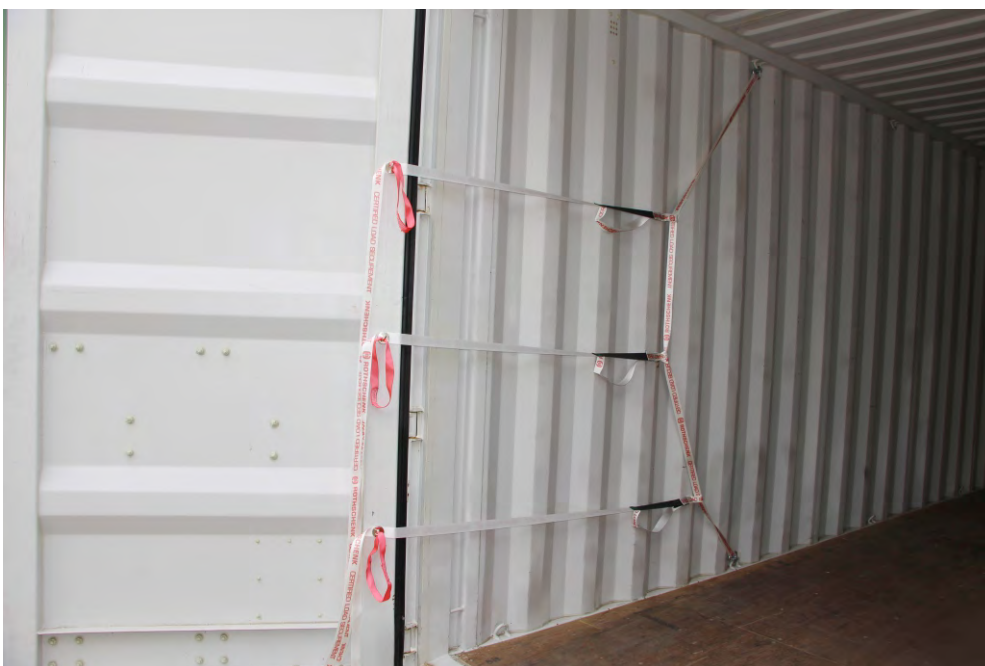
Spannfunktion durch Gummiband
