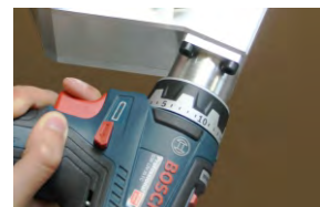
Flexible Vorwahl der Vorspannkraft
