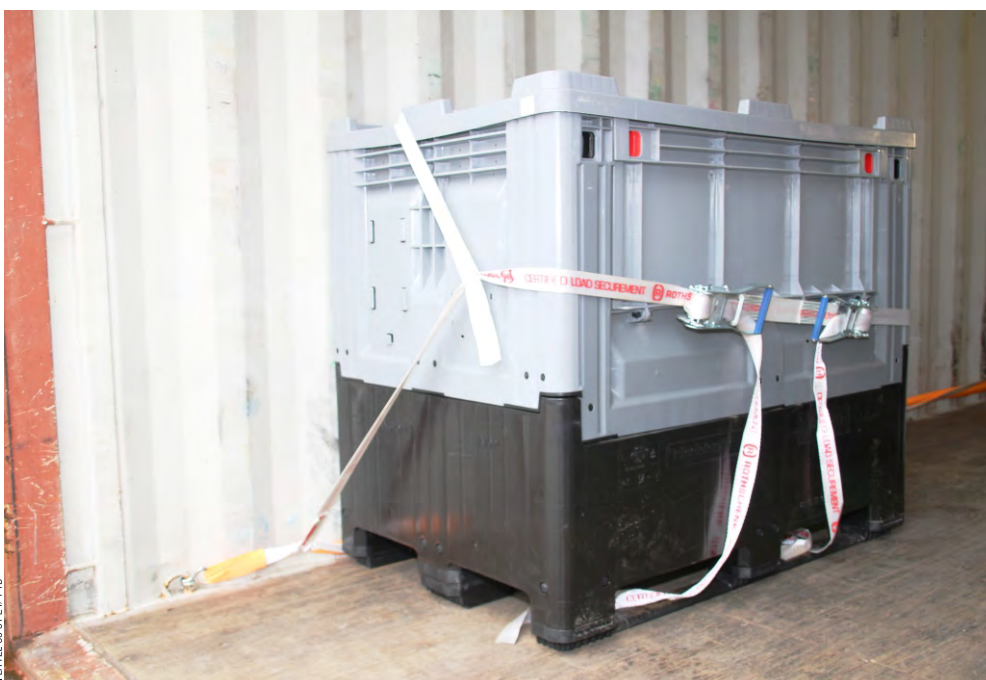
Flex. Zurrpunkte längs der Containerwand
