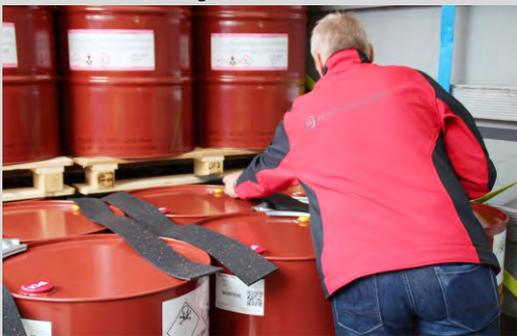
3. Doppelstock verladen. Antirutschmatten unterlegen.
