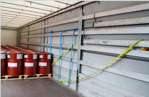
2. TruckLash einhängen, an den Bordwänden fixieren.
