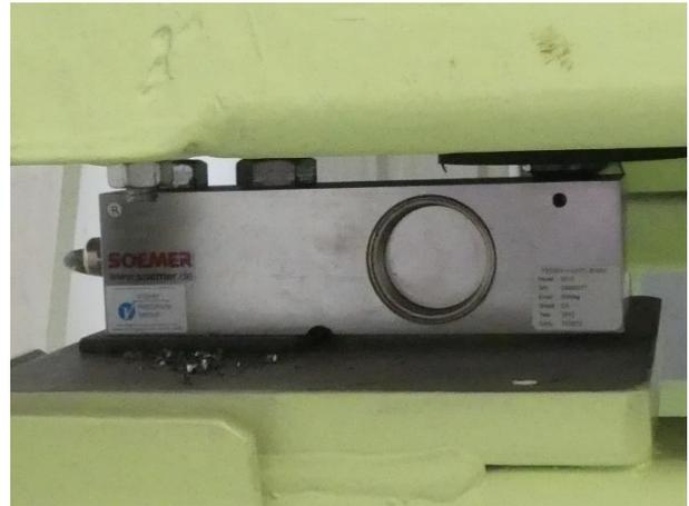
Abb. 6 Druckmessdose
