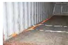
flex. Zurrpunkte längs der Containerwand
