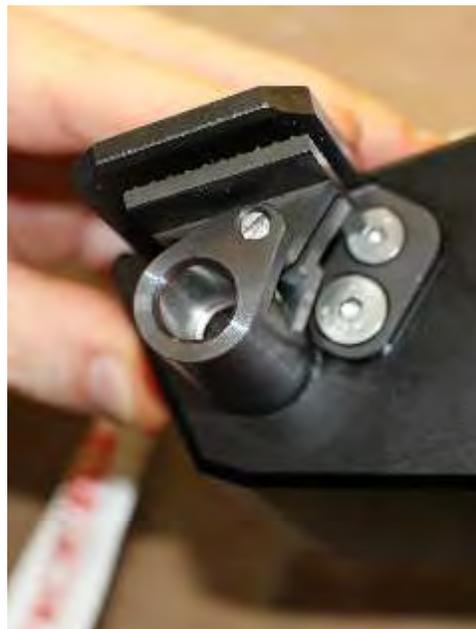
automatisch öffnende/schließende Bandbremse
