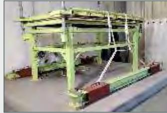
**Zugtest-Anlage für Umreifungs- und Ladungssicherungsänder**
