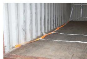
flex. Zurrpunkte längs der Containerwand
