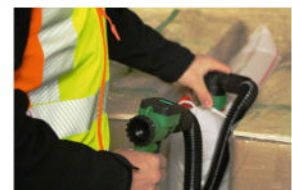
digitale Füllpistole mit Manometer
