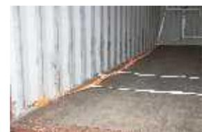
flex. Zurrpunkte längs der Containerwand
