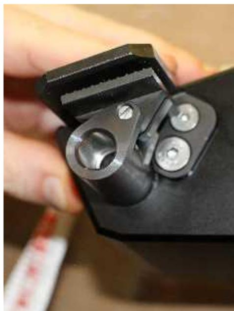
automatisch öffnende/schließende Bandbremse
