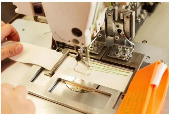
Abb. 6: Eine Mitarbeiterin an der Industrienähmaschine befestigt ein Querband am Trägerband des Lashing-Systems (Foto: G&H GmbH Rothschenk).
