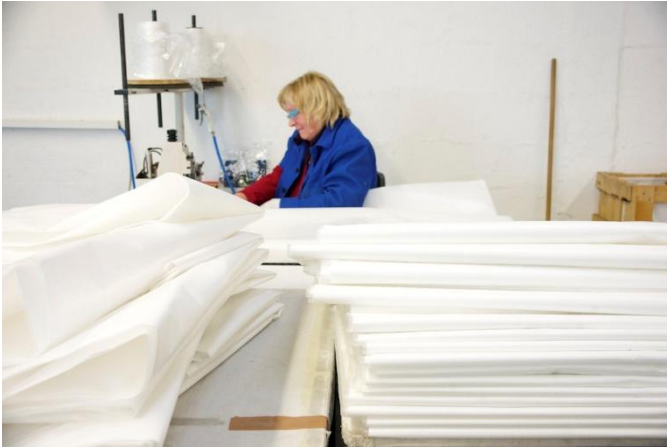
Abb. 4: Eine Mitarbeitende näht an der Industrienähmaschine Außensäcke aus PP-Bändchen-Schlauchgewebe (Foto: G&H GmbH Rothschenk).
