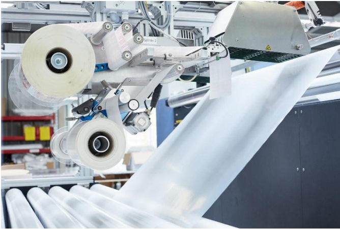
Abb. 1: Ein Schneid- und Schweißautomat zur Verarbeitung der PE-Schlauchfolie und des PP-Bändchen-Schlauchgewebes für die Produktion der Stausäcke (Foto: G&H GmbH Rothschenk).
