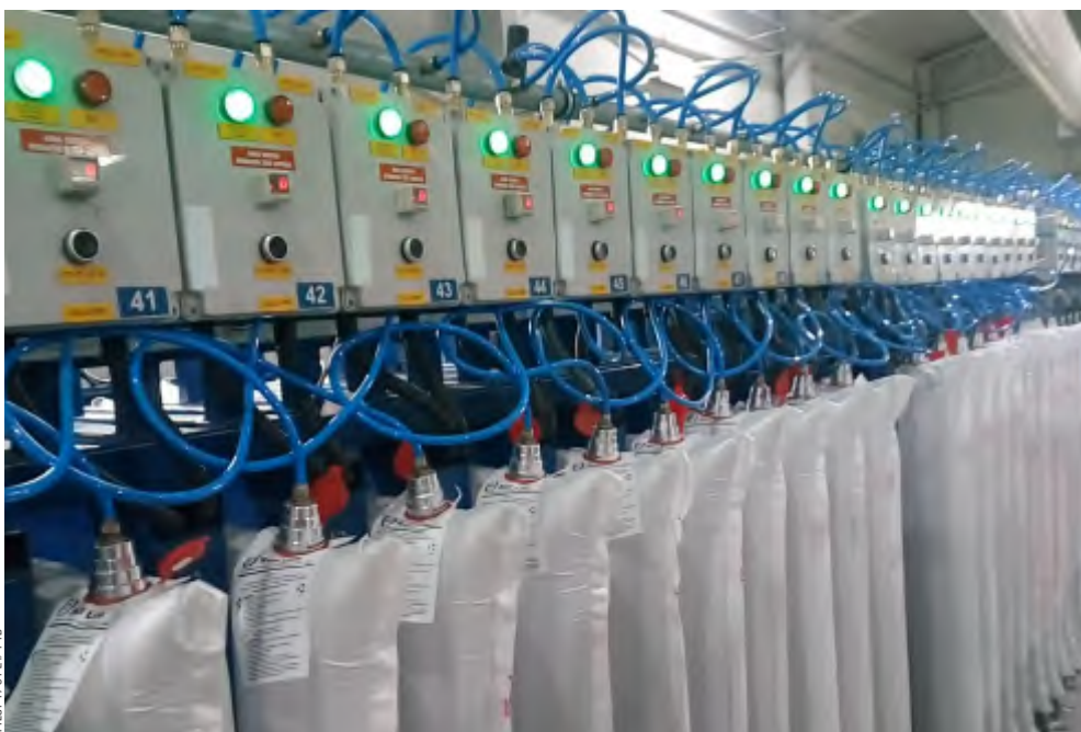
Pressure test edge protectors
