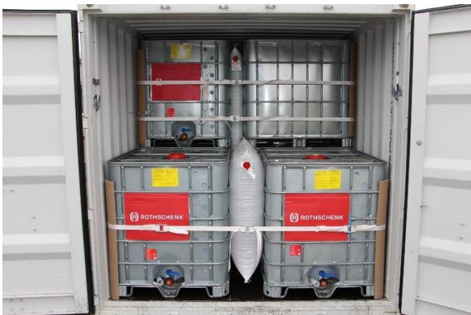
Abb. 1: 18 Kombinations-IBC mit Air-Bag
