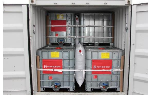
Abb. 6: Finalisieren untere Lashings mit 1/4-Schalen
