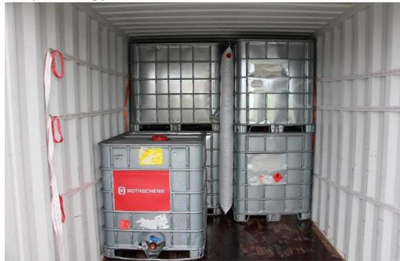
Abb. 4: Formschlüssiges Stauen im Container 90° versetzt
