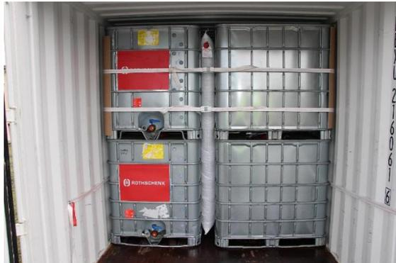
Abb. 5: Finalisieren obere Lashings mit 1/4-Schalen
