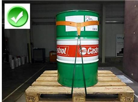
Abb. 1 und 2: Metallfass mit PET-Band und PE-Fass mit Polyesterband und Metallhaken-Fixierung
