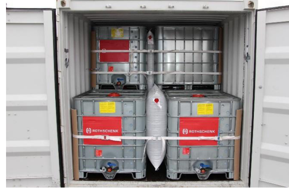
Abb. 6: Finalisieren untere Lashings mit 1/4-Schalen
