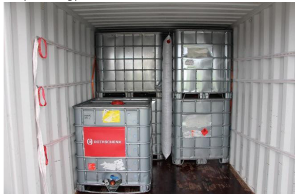
Abb. 4: Formschlüssiges Stauen im Container 90° versetzt
