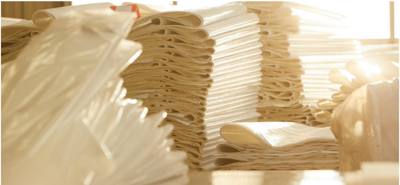
Abb. 19: PP-Gewebe und PE-Folie in der Produktion am Standort Aub. Beide Materialien werden für die Herstellung der Stausäcke benötigt (Foto: G&H GmbH Rothschenk).
