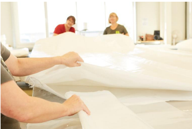
Abb. 3: Mitarbeitende beim Falten und Einschieben der PE-Innensäcke in den PP-Außensack (Foto: G&H GmbH Rothschenk).
