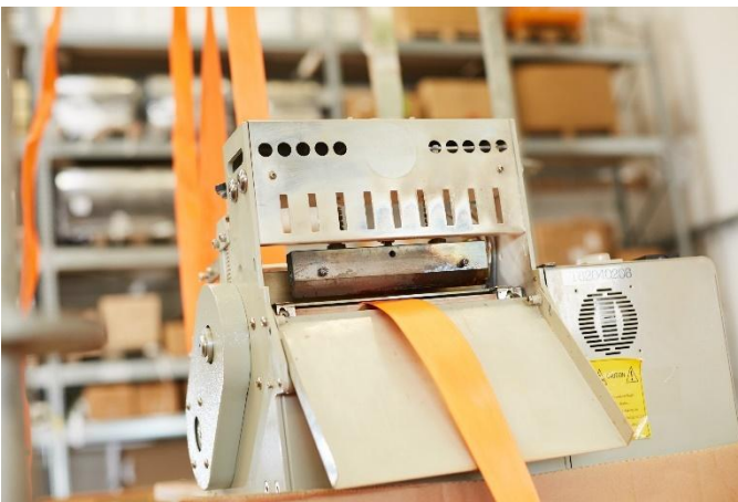
Abb. 5: Unsere Anlage zum Schneiden der Gurtbänder für die Lashing-Systeme (Foto: G&H GmbH Rothschenk).
