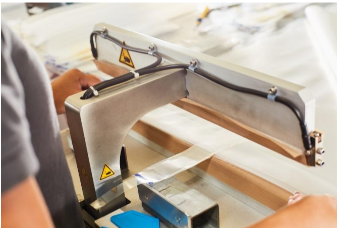
Abb. 2: Eine Mitarbeitende schweißt an einer Schweißzange ein Einweg-Ventil an den PE-Innensack (Foto: G&H GmbH Rothschenk).
