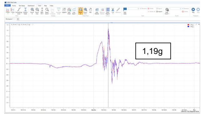
Abb. 5: Rückwärtsbremsung aus ca. 7 km/h auf LKW
