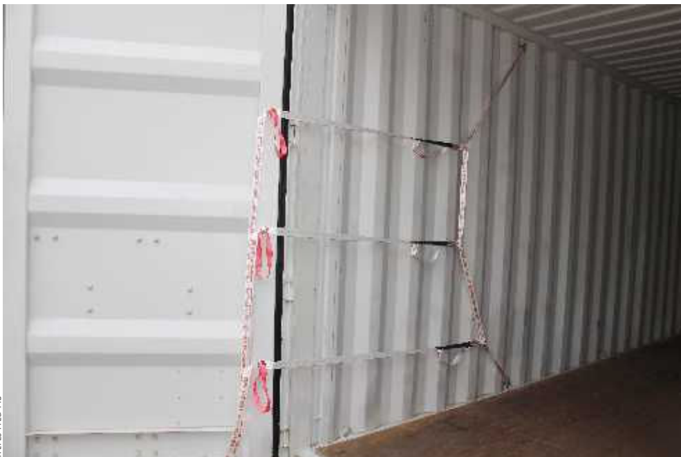
Spannfunktion durch Gummiband
