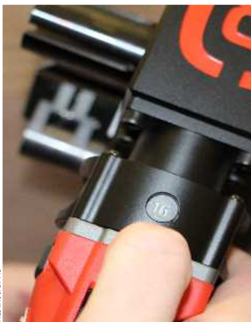
einstellbarer Drehmoment für reproduzierbare Vorspannkräfte
