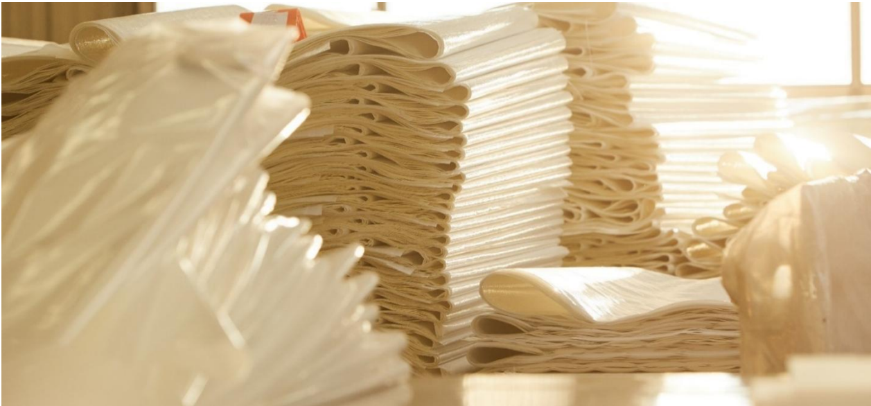
Abb. 14: PP-Gewebe und PE-Folie in der Produktion am Standort Aub. Beide Materialien werden für die Herstellung der Stausäcke benötigt (Foto: G&H GmbH Rothschenk).
