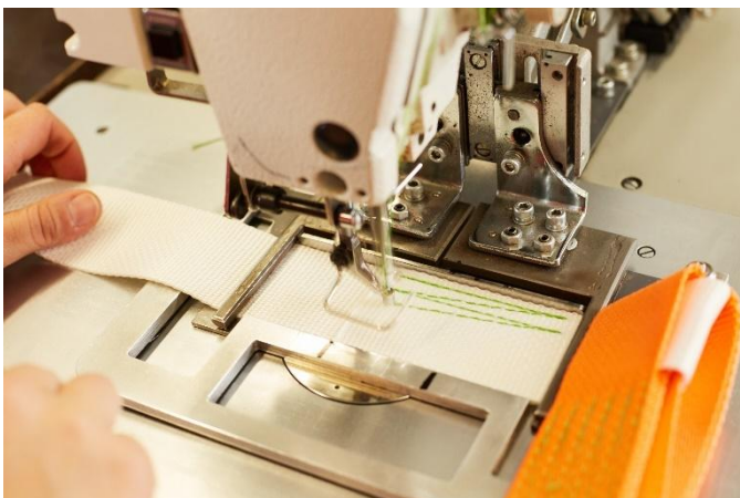
Abb. 3: Eine Mitarbeiterin an der Industrienähmaschine befestigt ein Querband am Trägerband des Lashing-Systems (Foto: G&H GmbH Rothschenk).
